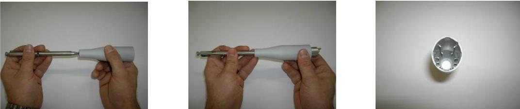
3. Reinigen Sie den Bereich der Strömungskanäle trocken mit einem Pinsel. Wischen Sie danach die gesamte Motorbaugruppe, den Motormantel und die Schlauchgarnitur mit einem dafür geeigneten Reinigungstuch ab.
