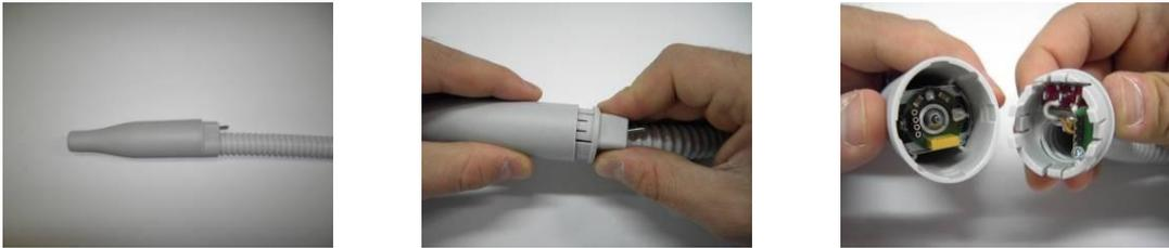
2. Schieben Sie die komplette Motorbaugruppe mit Spanmechanismus aus dem Handstückmantel heraus.
