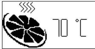
Nach Absinken der Temperatur im Saugturbinegehäuse um ca. 10 - 15 °C verschwindet diese Anzeige und das Gerät befindet sich wieder in Betriebsbereitschaft.
