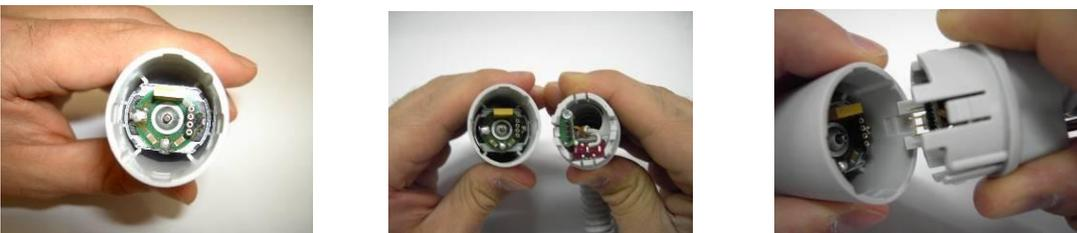
5. Setzen Sie die Steckverbinder beim Zusammenbau des Motoranschlusses vorsichtig an und stecken Sie den Motoranschluss mit der Schlauchgarnitur zusammen. Achten Sie auf korrekte, gleichseitige Ausrichtung der Steckverbinder, sodass die Kontaktpins nicht beschädigt werden.
